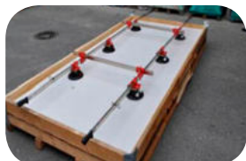
Ukázka přepravy a manipulace s ultratenkými velkoplošnými formáty dlaždic.
