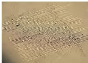
Vytvoříme mřížku cca 2 x 2 mm na prostoru cca 10 x 10 cm. V případě, že cca 80 % stěrkovací hmoty zůstává na místě, není třeba nové stěrky.
