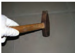
Poklepem na každou dlaždici zjistíme její stabilitu.
